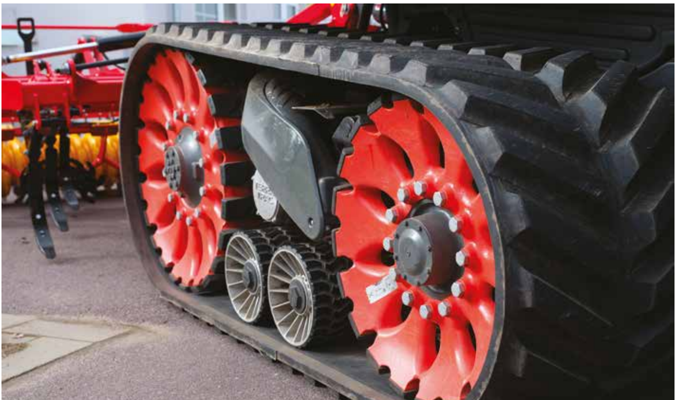
▲ Pásový podvozek TERRA TRAC pro traktory.
